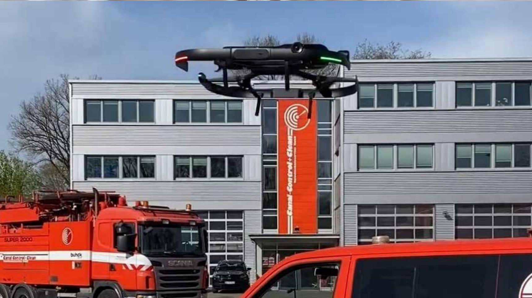
Als erstes europäisches Unternehmen haben wir seit 2022 eine Vermessungsdrohne im Einsatz. Diese kann autonom großflächige Areale vermessen und liefert detaillierte Daten für Sanierungsmaßnahmen. Außerdem wird diese Drohne auch zur Vermessung innerhalb des Kanalsystems eingesetzt.
